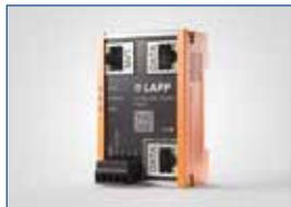
Attraverso la lettura e l'analisi dei parametri, confrontati con curve di riferimento, il sensore smart identifica lo stato di usura del cavo e invia un alert al sistema di supervisione mediante, per esempio, il protocollo MQTT. La funzione di diagnostica è basata sull'algoritmo Lapp Predictive Indicator,
