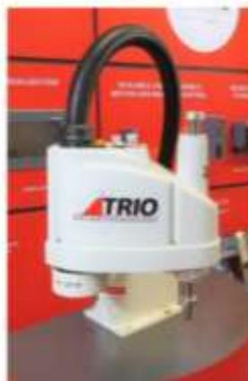
TRIO MOTION TECHNOLOGY annuncia la produzione di una linea di robot accessibile anche per utenti con una limitata esperienza di robotica. Adatta alle aziende di produzione elettronica, imballaggio e movimentazione dei materiali, la gamma comprende quattro robot SCARA che vanno da un braccio di 400 mm e una capacità di carico massima di 3 kg, fino a un braccio di 700 mm e una capacità di carico massima di 6 kg. Ogni robot è costituito da quattro servomotori
