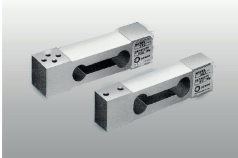
Cella di carico basso costo e basso profilo del tipo fuoricentro (off-center), per piattaforme di pesatura, bilance o altre applicazioni industriali a singolo punto di misura con piattaforma massima di 400x400mm. Il rivestimento delle parti elettriche e dei sensori con silicone conferisce un grado di protezione contro polveri e liquidi di grado IP67.
