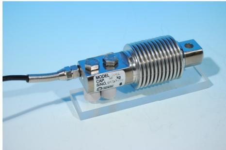
**DESCRIZIONE:** Cella di carico IP67 di tipo a flessione costruita in lega d'acciaio e con caratteristico soffietto interlamente saldato al laser. Adatto per la realizzazione di piattaforme di misura di peso a celle multiple e per altre innumerevoli applicazioni dinamiche.
