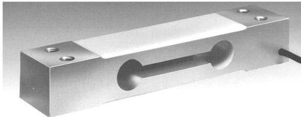
**DESCRIZIONE:** Cella di carico basso costo e basso profilo del tipo fuoricentro (off-center), per piattaforme di pesatura, bilance o altre applicazioni industriali a singolo punto di misura con piattaforma massima di 300x300mm, particolarmente adatta per misure nel settore medicale, industriale e civile. Il rivestimento delle parti elettriche e dei sensori con silicone conferisce un grado di protezione contro polveri e liquidi di grado IP67.
